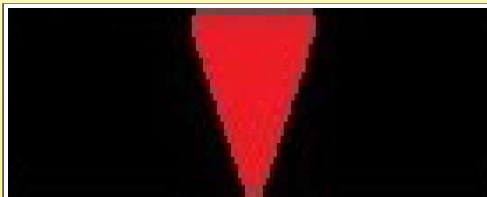
Шов, проваренный на всю толщину, без зазоров, стимулирующих появление коррозии
